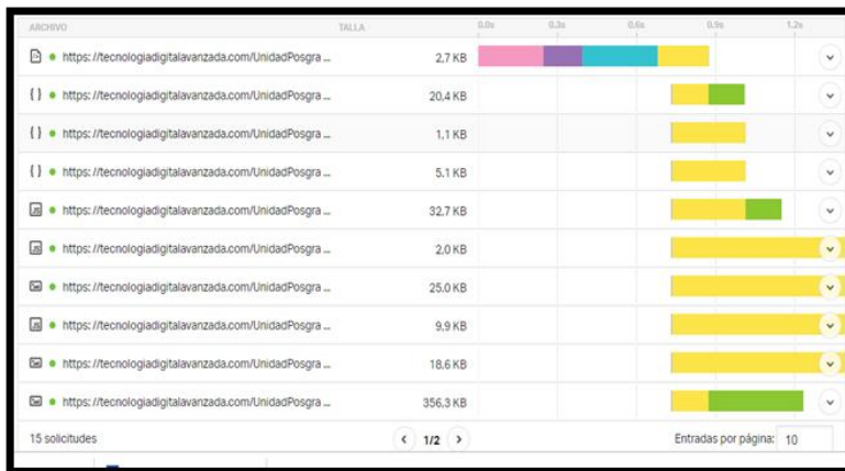
Figura 15. Análisis del Tiempo de Respuesta del Sistema de Información Web utilizando Pingdom Website Speed Test
